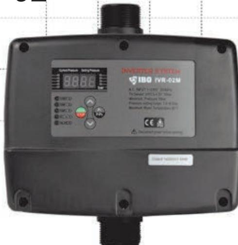
Интеллектуальный контроллер насоса, модель IVR-02M является легким в использовании управляющим и предохраняющим устройством для непосредственного подключения однофазных глубинных, поверхностных, погружных и т.п. насосов мощностью от 0,75 кВт до 1,5 кВт (от 1 л. с. до 2 л. с.), поддерживающим постоянное, заданное давление воды путем изменения скорости вращения двигателя насоса.
