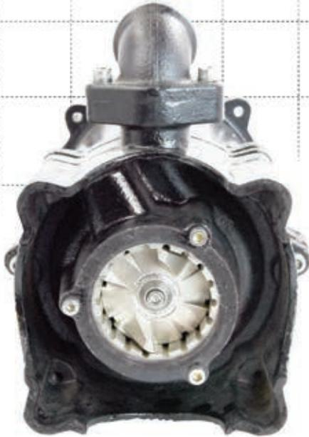
Насос UP60/80 оснащен двухступенчатой гидравликой, увеличивающей максимальное давление. Важной особенностью модели UP является многоканальный дисковый измельчитель, в котором риск блокировки сведен к минимуму. Кроме того, соединитель снабжен резьбовым патрубком, предназначенным для соединения трубопровода или быстроразъемного соединения. Насос имеет тепловую защиту, установленную в обмотке двигателя.
