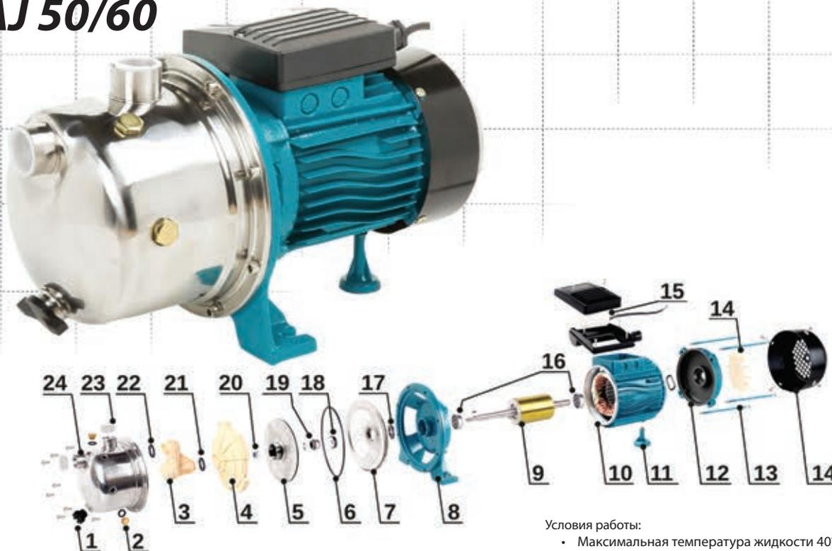
Одноступенчатый, самовсасывающий, центробежный поверхностный насос, оснащенный системой, увеличивающей мощность всасывания благодаря использованию трубки Вентури, предназначен для перекачивания чистой, холодной воды из собственных водозаборов и повышения давления. Корпус насоса и вал в части, контактирующей с водой, выполнены из нержавеющей стали (версия INOX). Насос имеет шнур питания с вилкой. Двигатель насоса оснащен тепловой защитой.
