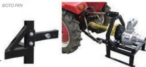
Насосы приводятся в действие валом отбора мощности (ВОМ). Требуемые обороты ВОМ трактора составляют 540 об / мин. Через вал отбора мощности (вал входит в комплект) обороты вала отбора мощности передаются на коробку передач с передаточным числом 6,6, которая приводит в движение насос. Минимальная мощность трактора, необходимая для привода насоса, составляет 15 л.с., максимальная 125 л.с.
