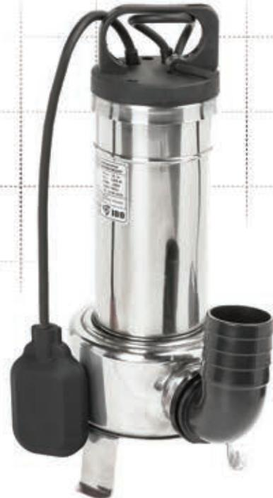
Погружные насосы из нержавеющей стали с системами измельчения. Предназначен для перекачки грязной воды и бытовых сточных вод. Использование открытого измельчителя снижает риск засорения до минимума. Благодаря высочайшему качеству нержавеющей стали, насосы обеспечивают длительную бесперебойную работу. Двигатель оснащен тепловой защитой, установленной в обмотке. Кроме того, насосы имеют поплавковый выключатель, который автоматически контролирует работу насоса.
